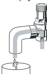
**ℹ️** Hafennáll az a veszély, hogy a lefúvató vezeték eldugulhat vagy befagyhat, szakítsa meg a lefúvó vezetéket, pl. egy tölcserrel. A tölcser lefolyó vezetékenél kétszer akkora keresztmetszete legyen, minta biztonsági szelep bemenetének
