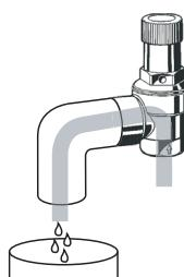
**i** Wenn Gefahr besteht, dass die Abblaseleitung verstopft wird oder einfrieren kann, eine Unterbrechung der Abblaseleitung vornehmen, z.B. durch einen Trichter. Die Ablaufleitung des Trichters muss den doppelten Querschnitt des Sicherheitsventil-Eingangs haben
