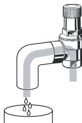
**i** Si la conduite de décharge risque d'être bouchée ou de geler, sactionner la conduite en intégrant un entonnoir, p. ex. La conduite d'évacuation de l'entonnoir doit avoir une coupe transversale deux fois plus grande que l'entrée de la soupape de sécurité
